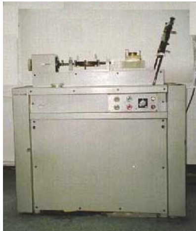
Aparat bezpośredniego ścinania – widok ogólny
